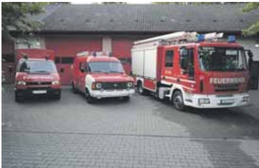
Das Feuerwehrgerätehaus Am Sportplatz mit den Fahrzeugen MTF-L für 5 Mann Besatzung (links), TSF für 6 Mann Besatzung (Mitte) und StLF 10/10 für 6 Mann Besatzung und 1000 Liter Wasser.
